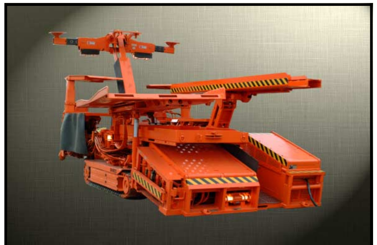
Accionamiento por oruga, opcional, y sistema de manipulación de materiales
